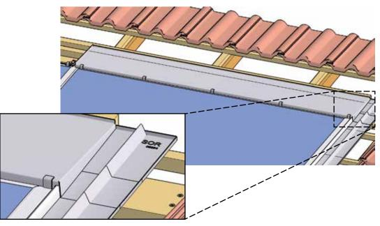
Fig. 57: Insert flashing top right
