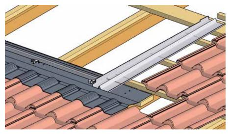
Fig. 37: Flashing side right
